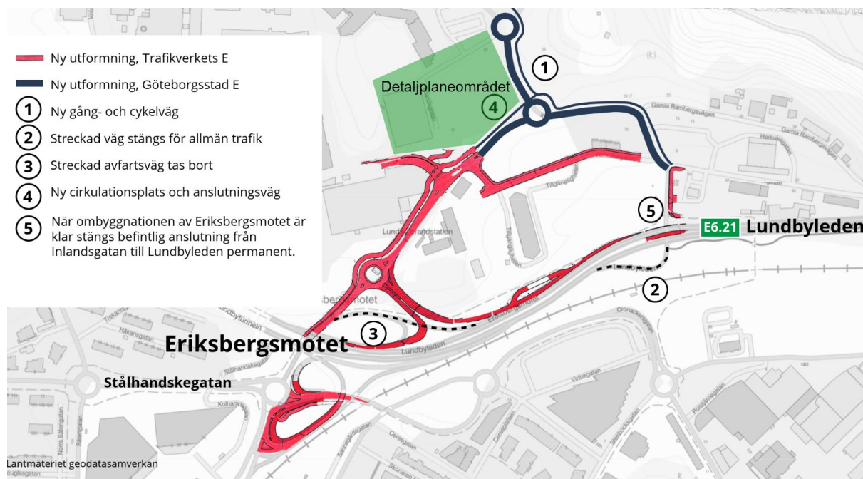
Figur 5, Ombyggnation av Eriksbergsmotet – Inlandsgatan blir färdigt hösten 2024 (Källa: Trafikverket).
